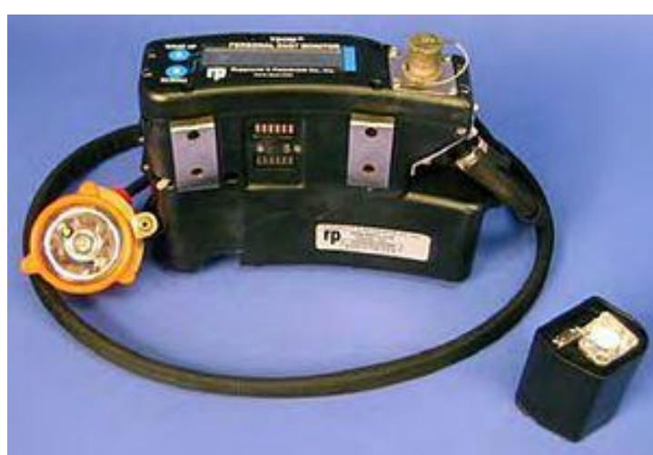
*Şəkil 5.3. Tozun miqdarını ölçən cihaz*
