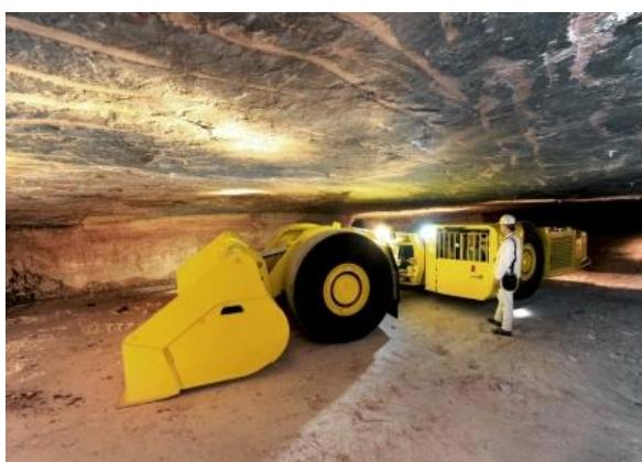
*Şəkil 2.24. Toro firmasının yükləyici-daşıyıcı машынını*
