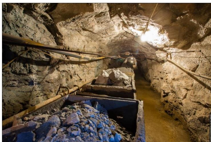
Şəkil 2.32. Filizin nəql etdirilməsi
