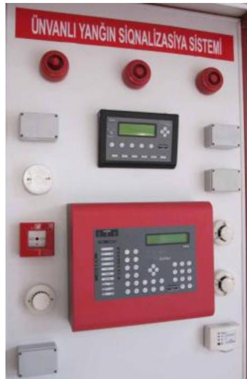
Şəkil 4.12. Yanğın siqnalizasiya sistemi
