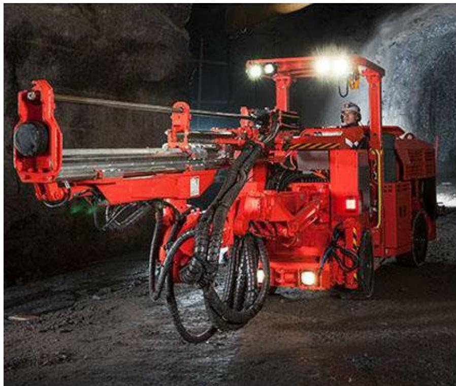
*Şəkil 1.13. Sandvik DD211 kiçik enkəsikli qazmalarda işləmək üçündür.*
