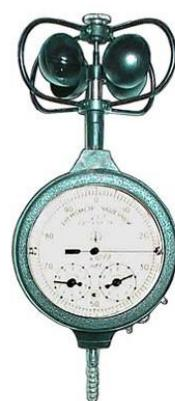
Şəkil 5.5. Fincanlı anemometr
