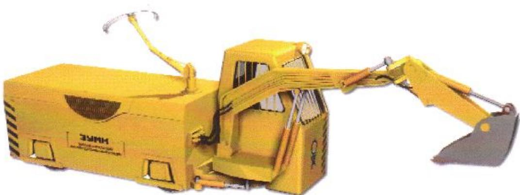
Şəkil 2.39. Xəndəklərin təmizlənməsi üçün maşın M3K
