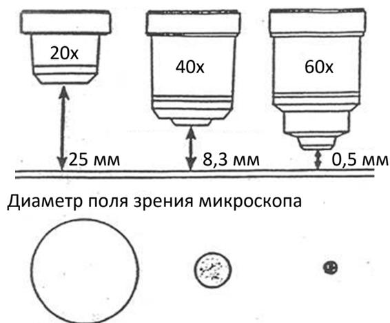
Диаметр поля зрения микроскопа
