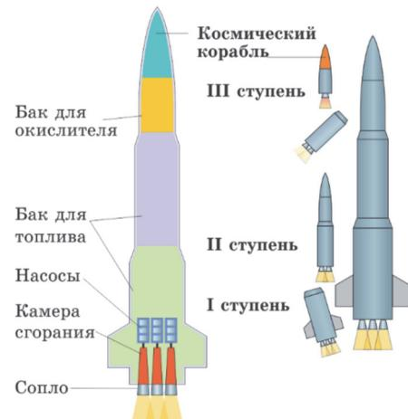
**рис.1.** Схема ракетоносителя и трехступенчатого ракетоносителя
