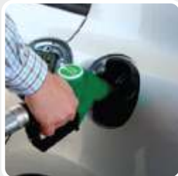
Бензонасос перекачивает примерно 50 л бензина в минуту
