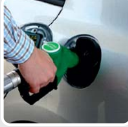
Benzin pompası dəqiqədə təqribən 50 litr benzin pompalayır
