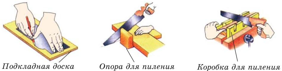
Рис. 3. Приспособления для работы с древесиной
