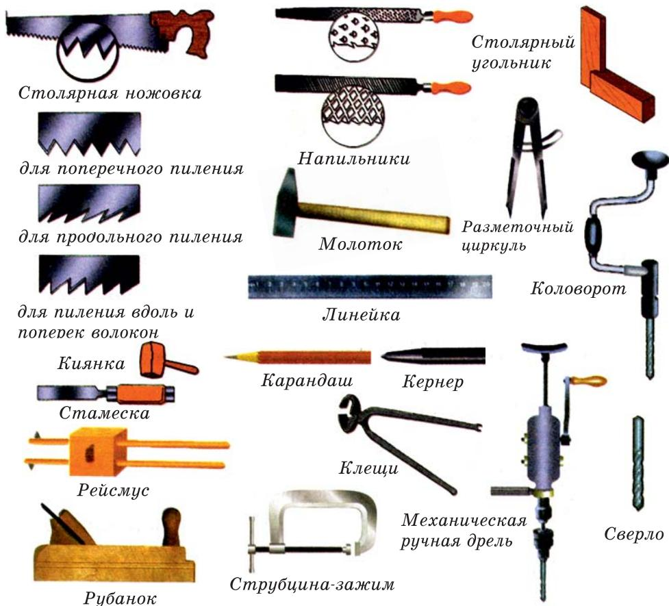
Рис. 2. Инструменты для работы с древесиной
