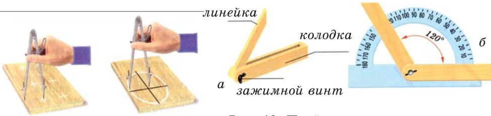
Рис. 9. Приёмы разметки циркулем
