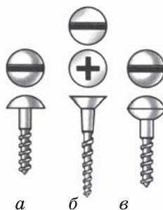
**Рис. 3. Шурупы с различными головками**
