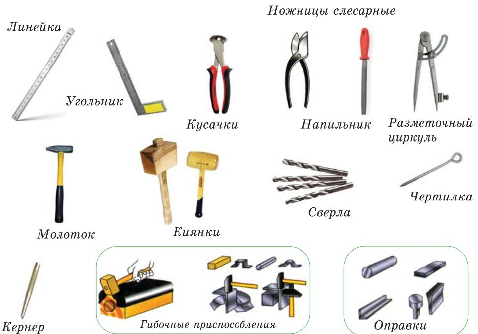
*Рис. 3. Инструменты и приспособления для обработки металла*
