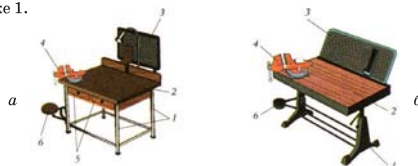
Рис. 1. Верстаки: а – слесарный; б – комбинированный: 1 – металлический каркас; 2 – столешница (крышка); 3 – защитная сетка (экран); 4 – тиски; 5 – ящики для инструментов; 6 – сиденье
