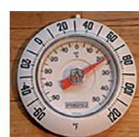
Müəllimin izahı: Müəllim temperaturun Selsi və Farengeyt dərəcələri haqqında məlumat verir. Mövzu haqqında məlumatı kompüter programlarında hazırlanmış təqdimatla vermək olar. Şəkildə temperaturu Selsi və Farengeylə ölçmək üçün otaq termometri təsvir edilmişdir.
