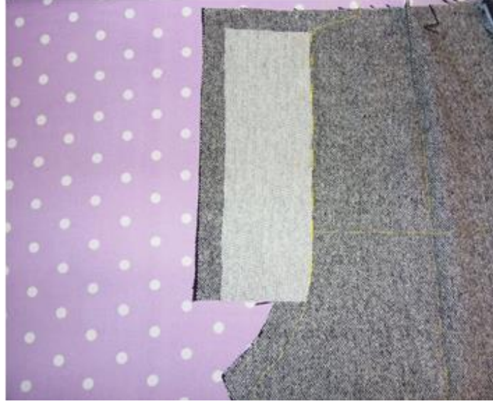
Şəkil 3.38. Bağlama yerinin yapışqanlı araqatı ilə işlənməsi
