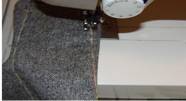
Şəkil 3.30. Ön yarım hissədə qarsaqların tikilməsi
