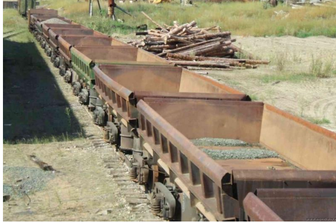
Şəkil 4.22. Karyerlərdə istifadə olunan vaqon-dumpkar
