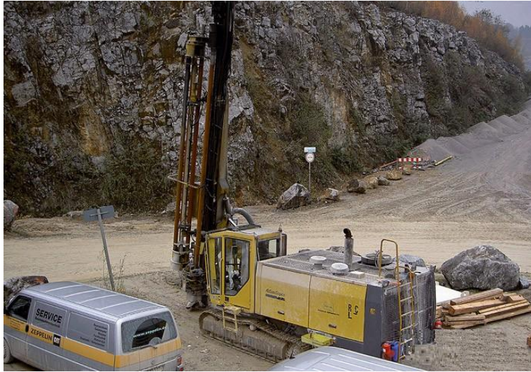
Şəkil 4.7. CBY-200 pnevmozərbə qazma dəzgahı
