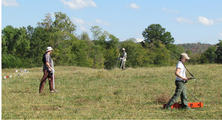
Şəkil 1.26. Maqnit kəşfiyyat üsulu
