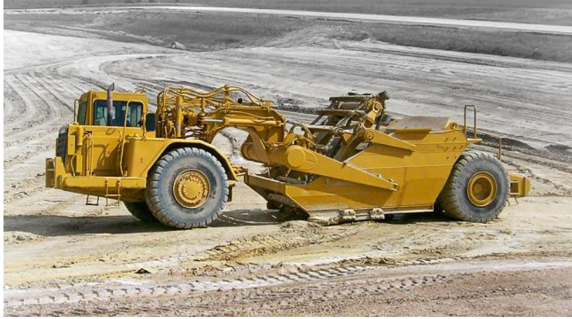
Şəkil 4.3. Təkərli skreper
