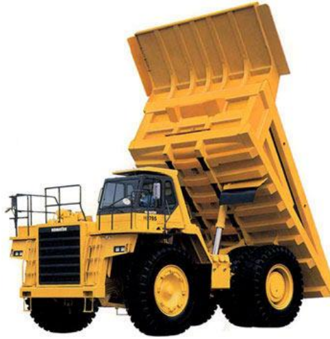
Şəkil. 1.36. Karyerdə istifadə olunan yükünü özü boşaldan maşın
