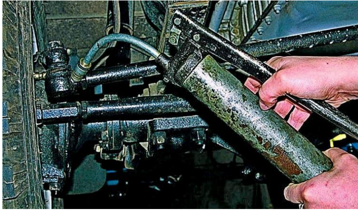
Şəkil 4.28. Qrafit yağının şprislə vurulması
