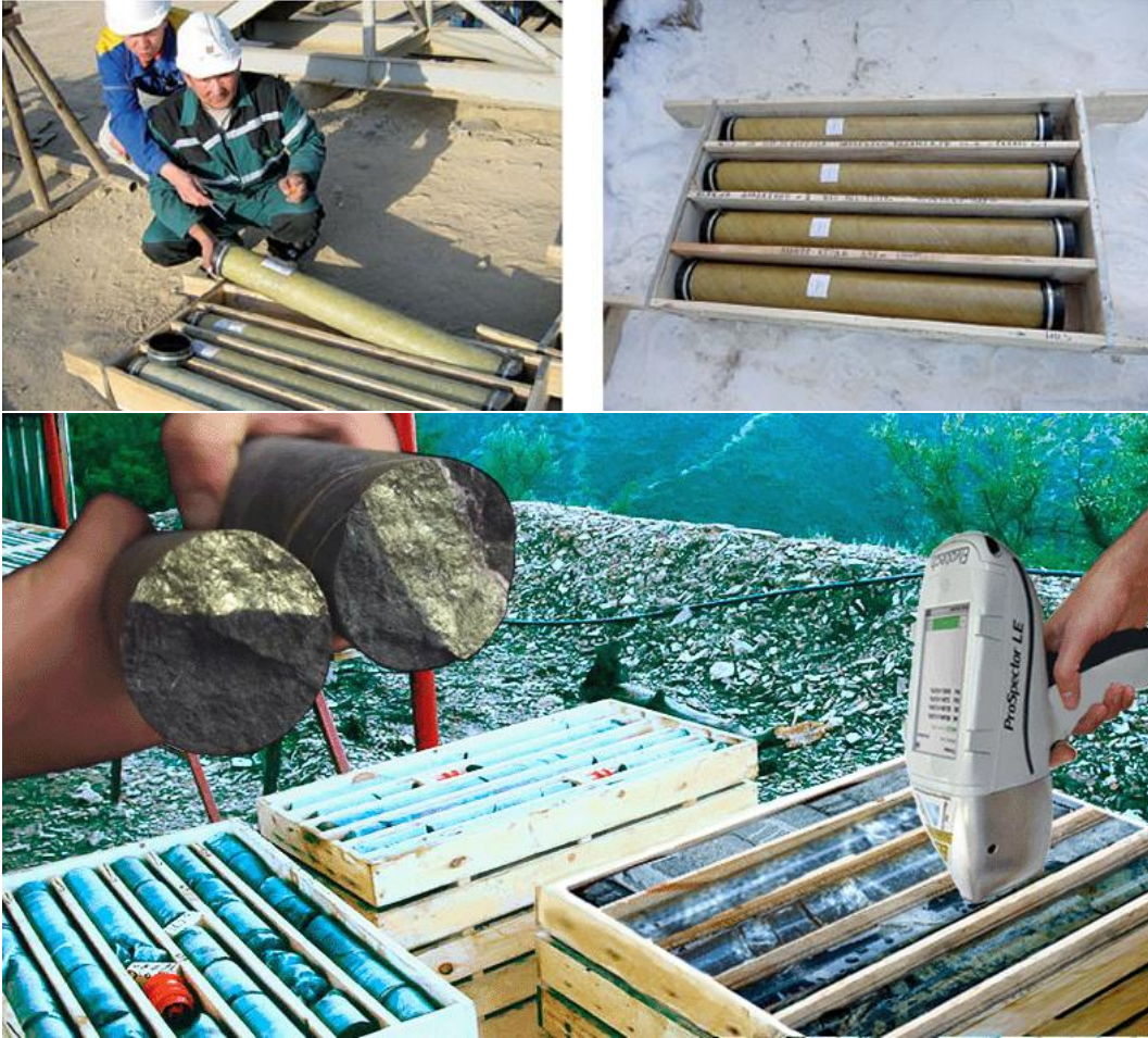
Şəkil 1.30. Kəşfiyyat zamanı alınan kernlər
