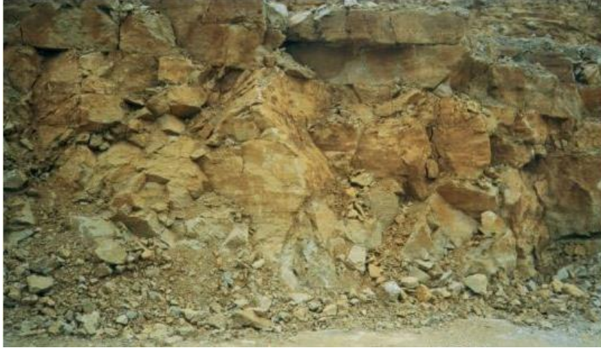
Şəkil 1.10. Partlayışsız çıxarılan yarımqaya süxur
