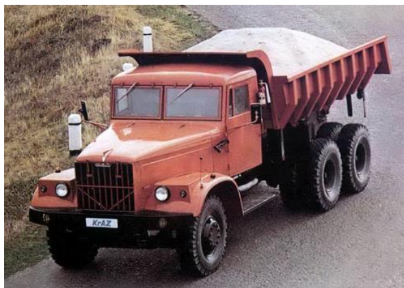
Şəkil 4.15. КрА3 yükünü özü boşaldan maşını
