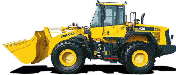
Şəkil 4.4. Komatsu firmasının birçömçəli yükləyicisi
