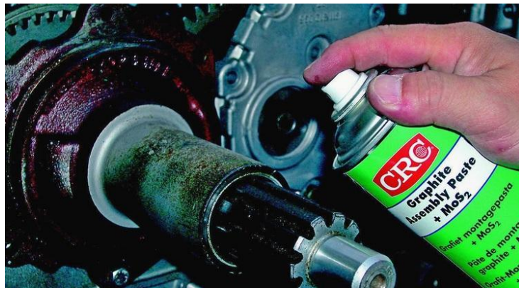
Şəkil 4.29. Aerosol halında qrafit yağının çilənməsi
