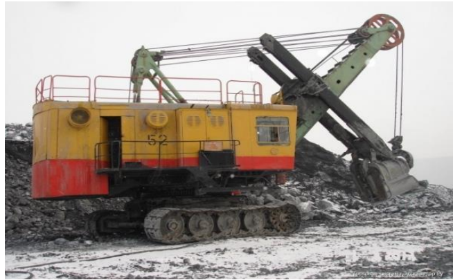
Şəkil 4.10. Düz belli ekskavatorun karyerdə işi
