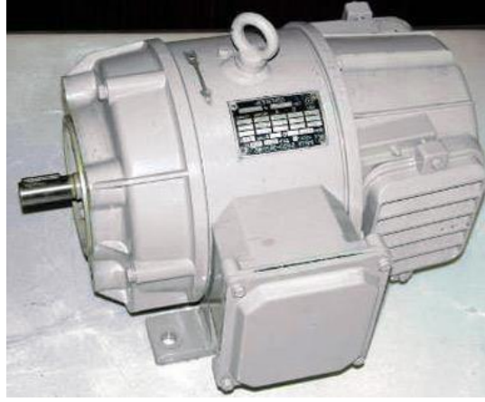
Şəkil 3.16. II seriyasından olan elektrik mühərriki
