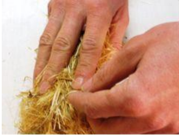
Şəkil 1.19. Doldurucu materialın yerləşdirilməsi
