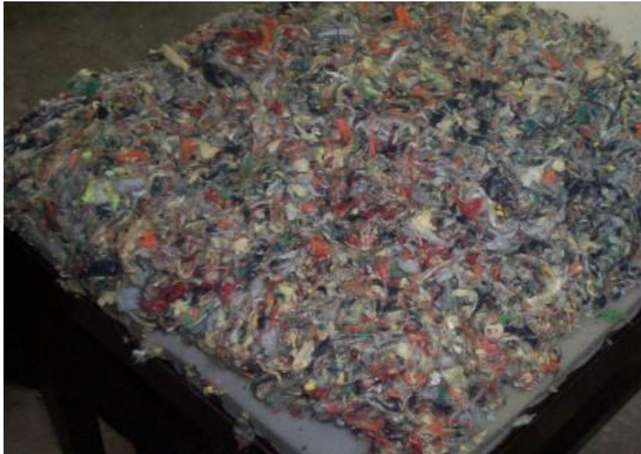
Şəkil 3.9. Təbii doldurucunun oturmağın səthinə sərilməsi
