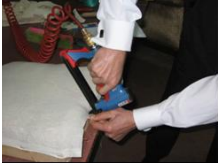
Şəkil 1.23. Oturacağın kətanla bağlanması başa çatdırılması
