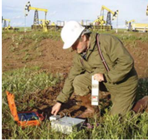
Torpağın temperaturunun ölçülməsi
