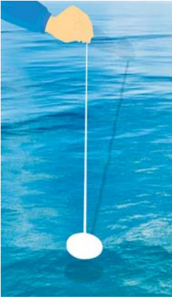
Suyun şəffaflığının təyin edilməsi
