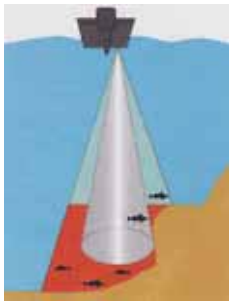
Müasir dövrdə okeanlarda suyun dərinliyi exolotun köməyi ilə təyin olunur
