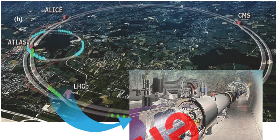
(b) – “Böyük Adron kollarideri”nin sxemi. Burada ATLAS (A Toroidal LHC ApparatuS), ALICE (A Large Ion Collider Experiment), LHCb (Large Hadron Collider beauty experiment) və CMS (Compact Muon Solenoid) BAK-da aparılan eksperimentlərin adıdır.
