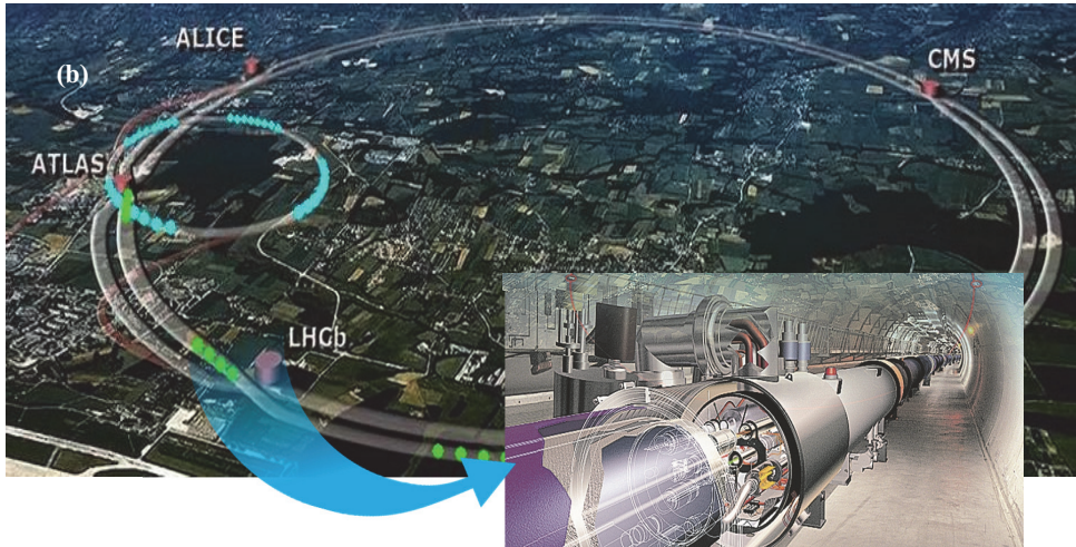
(b) – “ Böyük Adron kollayderi ”nin sxemi. Burada ATLAS (A Toroidal LHC Apparatus), ALICE (A Large Ion Collider Experiment), LHCb (Large Hadron Collider beauty experiment) və CMS (Compact Muon Solenoid) BAK-da aparılan eksperimentlərin adıdır.
