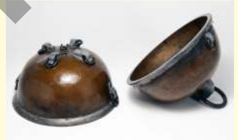
Atmosfer təzyiqini nümayiş etdirmək üçün istifadə olunan Maqdeburq yarımkürələri
