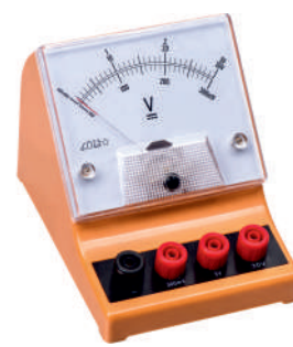
Voltmetr: gərginliyi ölçən cihaz – qövsvari şkala
