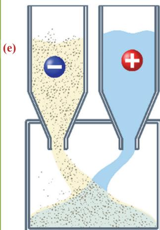
На предприятиях по выпечке хлеба самой тяжелой работой считается смешивание большой массы муки с водой, разбавленной сметаной, и получение однородного теста. На современных хлебопекарнях этот процесс выполняют автоматические устройства, принцип работы которых основан на применении свойств электрического поля. На рисунке изображена упрощенная схема одной из таких установок (e).
