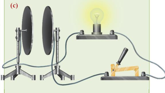
Известно, что простейшим конденсатором является плоский конденсатор, состоящий из двух параллельных пластин. Характеристикой конденсатора является электрическая ёмкость.
