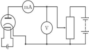
металла до высокой температуры кинетическая энергия свободных электронов в нем увеличивается и при определенной температуре они покидают металл – происходит *термоэлектронная эмиссия*. Принцип работы таких приборов, как вакуумный диод, электронно-лучевая трубка, рентгеновская трубка (трубка X-лучей) основан на явлении термоэлектронной эмиссии.
