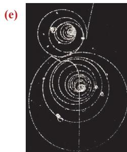
**Камера Вильсона.** *Камера Вильсона – это устройство, позволяющее наблюдать следы быстрых частиц, или сфотографировать эти следы. Действие устройство основано на конденсации перенасыщенного пара на ионах с образованием капелек воды.*
