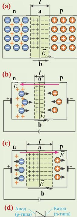
• **Полупроводниковый диод** – прибор, состоящий из одного p-n перехода и двух контактов для соединения в электрическую цепь. Полупроводниковый диод, обладая p-n переходом, проводит постоянный ток только в одном направлении. Односторонняя проводимость полупроводникового диода указывается особым знаком на схемах электрической цепи (d).
