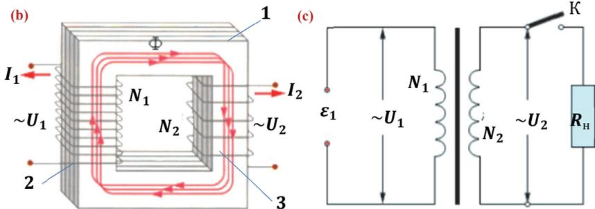
Переменный ток, проходящий через первичную обмотку, создает переменный магнитный поток, пронизывающий стальной сердечник и обе обмотки. Так как обе обмотки пересекает один и тот же магнитный поток, то в каждом витке этих обмоток возникает ЭДС индукции, равная  $\varepsilon_n = -\frac{\Delta\Phi}{\Delta t}$ .
