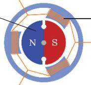
**Статор** – неподвижная часть генератора, состоит из проводящих витков.
