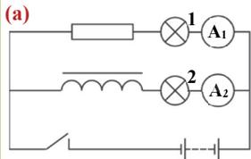
**Оборудование:** лампа (2 шт. по 4 В каждая); амперметр (2 шт.); катушка со стальным сердечником; резистор (эталон сопротивления); источник постоянного тока (выпрямитель); ключ; соединительные провода.
