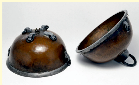
Магдебургские полушария, использованные для демонстрации атмосферного давления.
