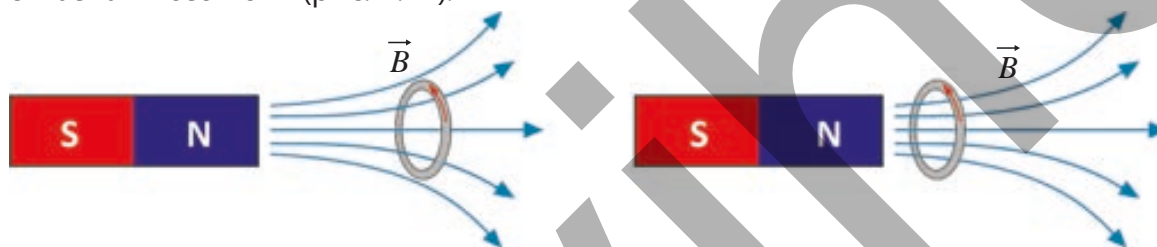
Рисунок 4.71. Изменение магнитного поля означает изменение числа индукционных линий.
