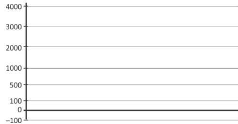
Б) По карте по линии А – Г измерим расстояния между точками пересечения линии профиля с горизонталями и нанесем их последовательно на горизонтальную линию. В конце каждого отрезка нарисуем перпендикуляр.
