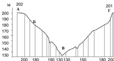
Профиль местности на основе горизонталей по линии А – Г в топографической карте
