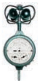
Анемометр (показывает скорость ветра)
