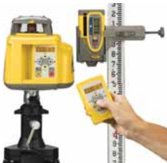
Нивелир – используется для планировки форм рельефа на местности
