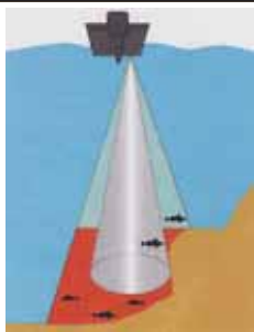
В современный период глубина воды в Океане, определяется с помощью эхолота
