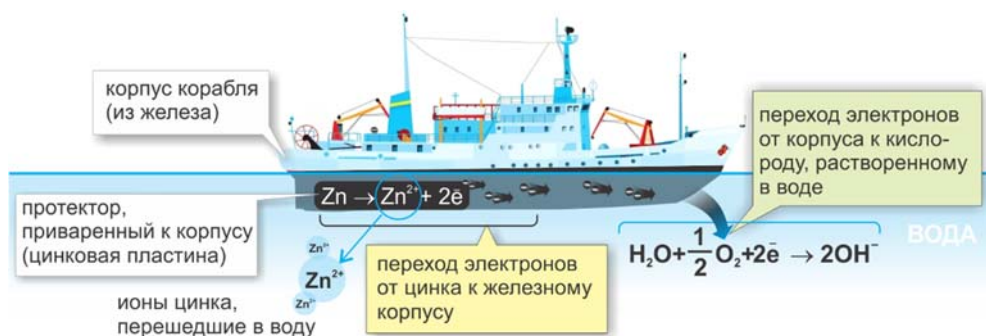
(d) Схема протекторной защиты корпуса корабля
