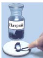
(a) Хранение натрия в керосине и его разрезание ланцетом
