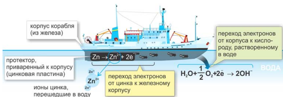
(d) Схема протекторной защиты корпуса корабля
