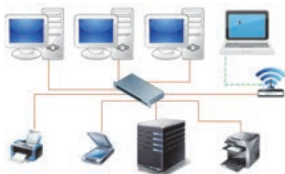
Схема типичной компьютерной сети
