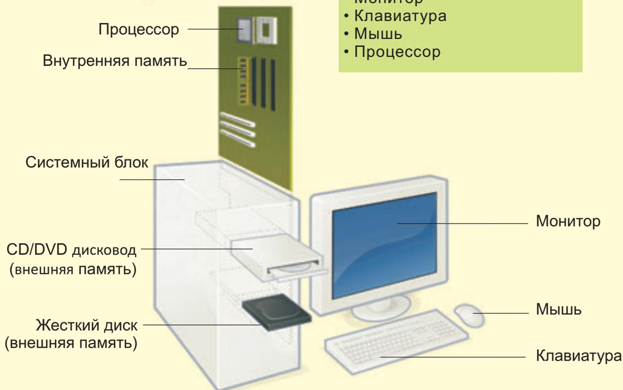
*Клавиатуру, монитор и системный блок называют **базовыми устройствами компьютера**. Современный компьютер невозможно представить без мыши. И поэтому *мышь*, которую раньше относили к дополнительным устройствам, сегодня считается базовым устройством компьютера.*
