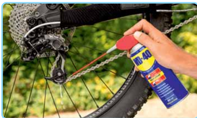
Смазка велосипедной цепи облегчает его движение.
