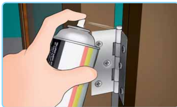
Чтобы дверные петли легко открывались и закрывались, их смазывают.
