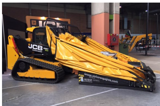
Şəkil 7.2. Qəbuledici çətirlə təchiz olunmuş meyvəyığan aqreqat
