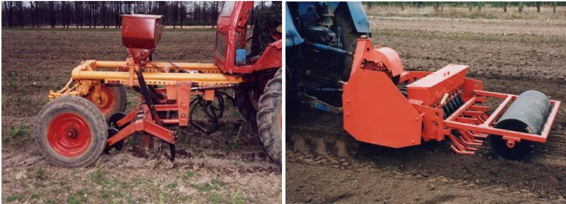
Şəkil 3.1. Tinglikdə eni 1,5 metr olan lentlərdə səpin aparən aqreqatlar
