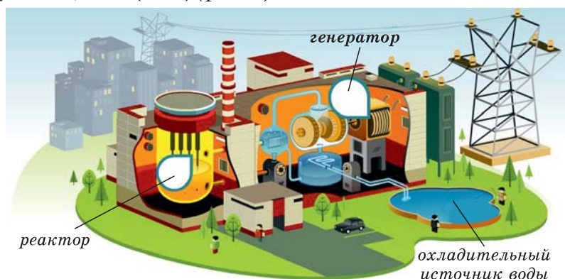
Рис. 3. Получение электроэнергии на АЭС
