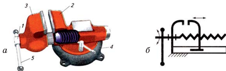
Рис. 2. Тиски: а – устройство тисков (1 – винт, 2 – неподвижная губка, 3 – подвижная губка, 4 – опорная плита, 5 – рукоятка); б – схема тисков
