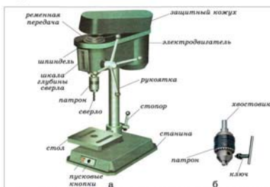
Рис. 1. а – устройство сверлильного станка НС-12; б – сверлильный патрон
