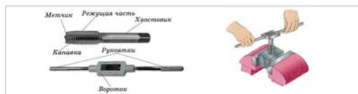
Рис. 7. Нарезание внутренней резьбы метчиком
