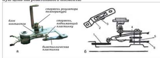
Рис. 3. а – терморегулятор; б – схема регулирования температуры; в – ручка терморегулятора
