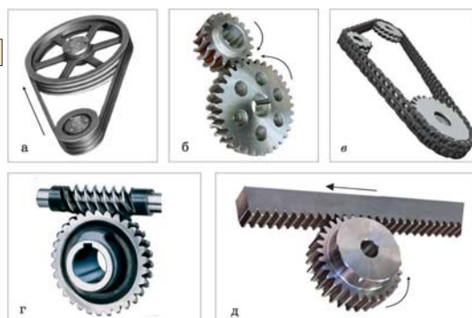
Рис. 2. Передаточные механизмы: а – ременная передача; б – зубная передача; в – цепная передача; г – винтовая передача; д – зубчато-реечная передача
