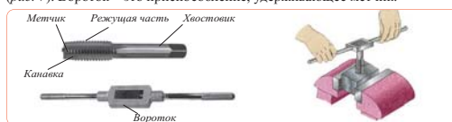
Рис. 7. Нарезание внутренней резьбы метчиком
