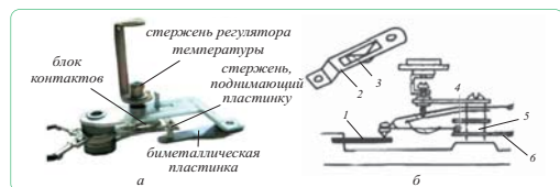
Рис. 3. а – терморегулятор; б – схема регулирования температуры
