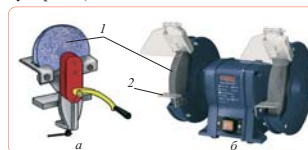
Рис. 1. а – ручной точильный станок; б – электрический точильный станок: 1 – точильный камень; 2 – упор
