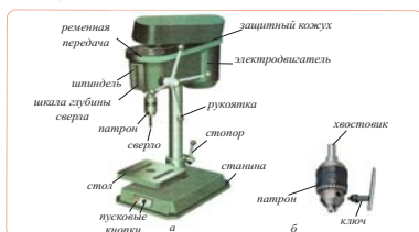
Рис. 1. а – устройство сверлильного станка; б – сверлильный патрон
