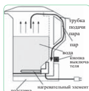
Рис. 2. Устройство электрического чайника
