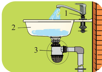
Рис 1. Устройство уmyвального: 1 – смеситель; 2 – раковина; 3 – сифон
