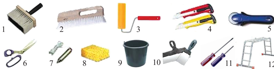
Рис. 1. Инструменты и приспособления для обойных работ: 1 – кисть для нанесения клея; 2 – щетка для разглаживания обоев; 3 – валик*; 4 – нож канцелярский для нарезки обоев; 5 – дисковый нож для подрезки влажных обоев у плинтусов и наличников; 6 – ножницы для нарезки полос обоев; 7 – отвес для контроля вертикальности обоев; 8 – губка для очистки поверхности материала; 9 – ведро для клея и воды; 10 – шпатель; 11 – отвертка для снятия верхней крышки выключателя и розетки; 12 – передвижной помост
