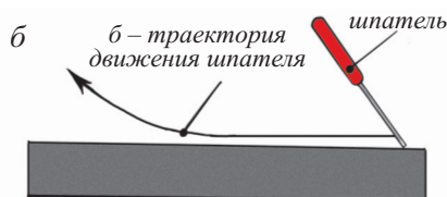
Рис. 5. Техника нанесения шпаклёвки: а – направление движения шпателя на стене; б – направление движения шпателя
