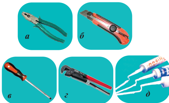
Рис. 4. Инструменты и приспособления для установки сифона
