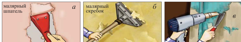
Рис. 1. Способы удаления красок: а, б – механический; в – термический
