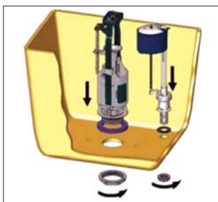
Рис. 6. Установка арматуры в сливной бачок
