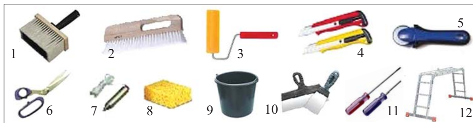
Рис.1. Инструменты и приспособления для обоевых работ: 1 – кисть для нанесения клея; 2 – щетка для разглаживания обоев; 3 – валик* ; 4 – нож канцелярский для нарезки обоев; 5 – дисковый нож для подрезки влажных обоев у плинтусов и наличников; 6 – ножницы для нарезки полос обоев; 7 – отвес для контроля вертикальности обоев; 8 – губка для очистки поверхности материалов; 9 – ведро для клея и воды; 10 – шпатель ; 11 – отвертка для снятия верхней крышки выключателя и розетки; 12 – передвижной помост
