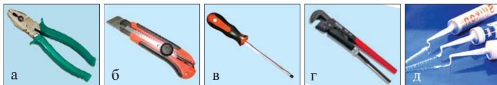
Рис. 4. Инструменты и приспособления для установки сифона
