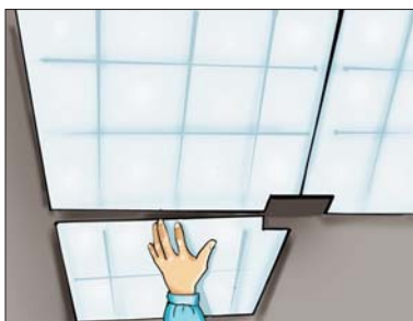
Рис. 3. Наклеивание плит к потолку
