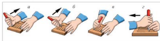
Рис. 5. Приемы резания косячком: а – одной рукой с наклоном ножа вправо; б – положение косячка в конце резания; в – с наклоном влево; г – двумя руками
