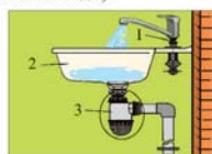
Рис. 1. Устройство умывальника: 1 – смеситель; 2 – раковина; 3 – сифон
