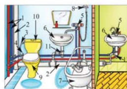
Рис. 1. Примерное устройство системы водоснабжения и канализации квартиры
