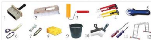
Рис. 1. Инструменты и приспособления для обоевых работ: 1 – кисть для нанесения клея; 2 – щетка для разглаживания обоев; 3 – валик*; 4 – нож канцелярский для нарезки обоев; 5 – дисковой пилой для подрезки влажных обоев у плинтусов и наличников; 6 – ножницы для нарезки полос обоев; 7 – отвес для контроля вертикальности обоев; 8 – губка для очистки поверхности материалов; 9 – ведро для клея и воды; 10 – шпатель; 11 – отвертка для снятия верхней крышки выключателя и розетки; 12 – передвигаемая полость
