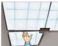
Рис. 3. Наклеивание плит к потолку
