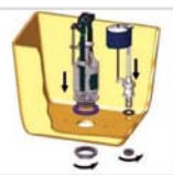
Рис. 6. Установка арматуры в сливной бачок
