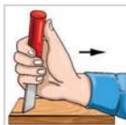
Рис. 4. Захват и положение инструмента при резке
