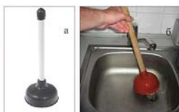
Рис. 6. Механическая чистка сифона вантузом: а – вантуз; б – чистка сифона вантузом
