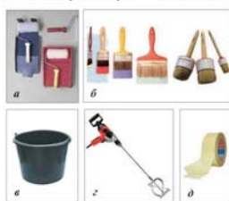
Рис. 2. Инструменты и приспособления для окрашивания: а – валики с ванной; б – кисти (плоские, круглые); в – ведро для краски; г – дрель-миксер; д – кисть для защиты стекла.
