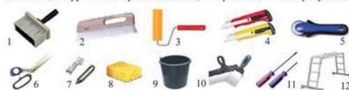
Рис. 1. Инструменты и приспособления для обойных работ: 1 – кисть для нанесения клея; 2 – щетка для разглаживания обоев; 3 – валик*; 4 – нож канцелярский для нарезки обоев; 5 – дисковый нож для подрезки влажных обоев у плинтусов и наличников; 6 – ножницы для нарезки полос обоев; 7 – отвес для контроля вертикальности обоев; 8 – губка для очистки поверхности материалов; 9 – ведро для клея и воды; 10 – шпатель; 11 – отвертка для снятия верхней крышки выключателя и розетки; 12 – передвижной помост
