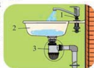
Рис. 1. Устройство умывальника: 1 – смеситель; 2 – раковина; 3 – сифон
