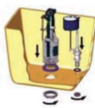
Рис. 6. Установка арматуры в сливной бачок
