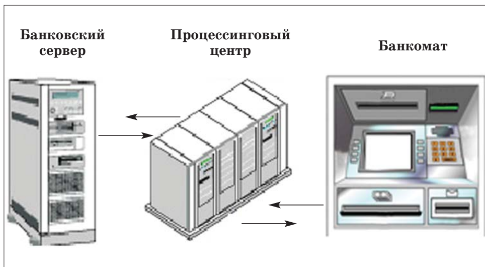
Рис. 9. Схема принципа работы банкомата
