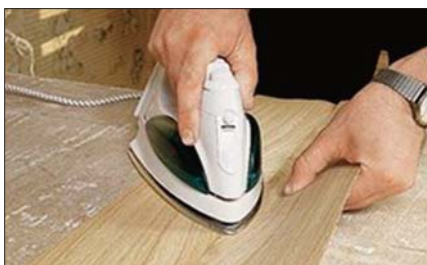
Рис. 8. Наклеивание шпона с помощью утюга
