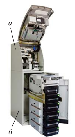
Рис. 2. Части банкомата: а) верхняя; б) нижняя
