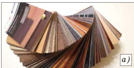
Рис. 7. Облицовочные материалы: а – бумажная пленка; б – бумажная мебельная лента
