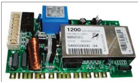
Рис. 5. Электронный блок управления
