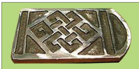
Рис. 5. Металл, отделанный методом травления
