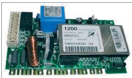
Рис. 5. Электронный блок управления
