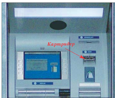
Рис. 3. Верхняя передняя часть банкомата
