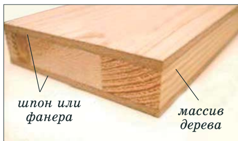
Рис. 4. Части столярной плиты
