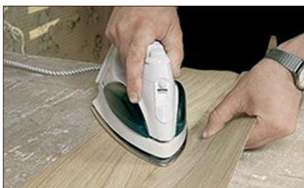
Рис. 8. Наклеивание шпона с помощью утюга
