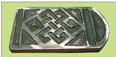
Рис. 5. Металл, отделанный методом травления
