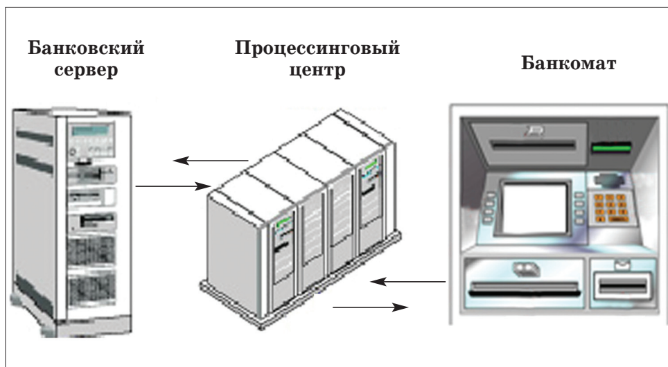
Рис. 9. Схема принципа работы банкомата
