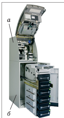
Рис. 2. Части банкомата: а) верхняя; б) нижняя
