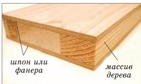
Рис. 4. Части столлярной плиты
