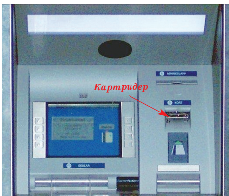
Рис. 3. Верхняя передняя часть банкомата
