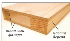
Рис. 4. Часть столлярной плиты
