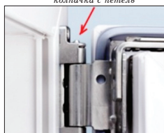
Рис. 4. Вынимание оси из петли
