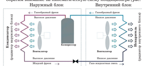
Рис. 5. Кинематическая схема кондиционера
