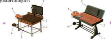
Şəh. 1. Verstaklar: a – çilingər verstakı; b – kombinə edilmiş verstak; 1 – metal karkas; 2 – stolüstü (qapaq); 3 – qoruyucu tor (ekran); 4 – məngənə; 5 – alətlər üçün yexiklər; 6 – oturmaq
