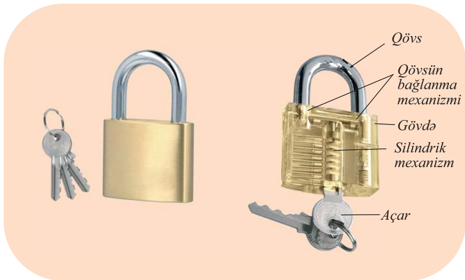
Şəkil 3. a - asma kilid; b - asma kilidin quruluşu
