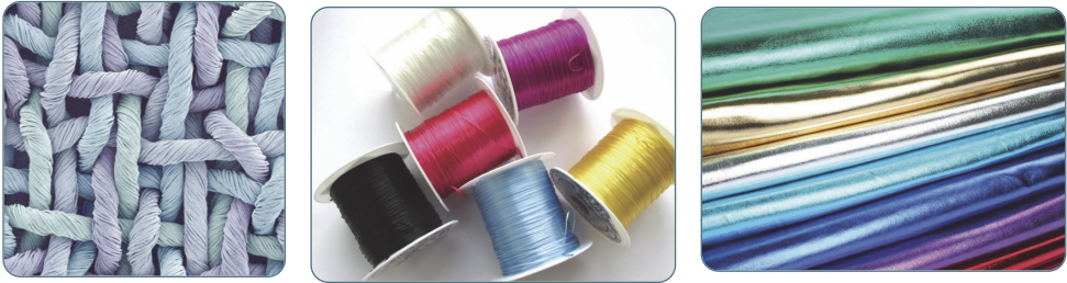
Şəkil 5. a – elastan lifinin quruluşu; b – elastan lifi; c – elastan parçası
