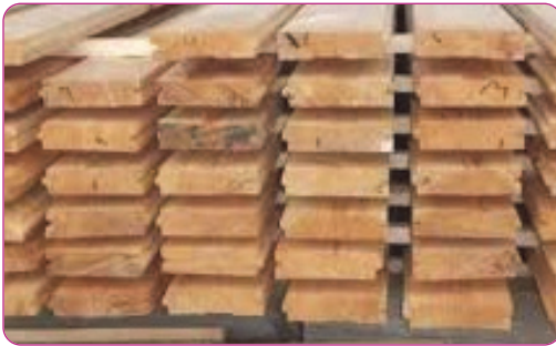
Şəkil 1. Mişar materiallarının təbii qurudulması
