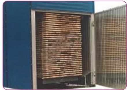
Şəkil 2. Mişar materiallarının qurutma kamerasında qurudulması
