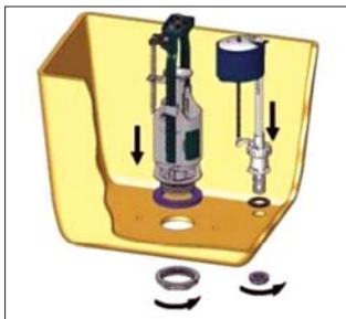
Şəkil 6. Axıdıcı çənə yeni armaturun quraşdırılması
