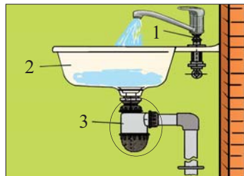
Şəkil 1. Əlüzyuyanın quruluşu: 1 – suqarışdırıcı; 2 – çanaq; 3 – sifon
