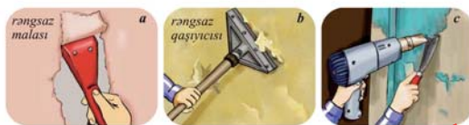
Şəkil 1. Rəngin çıxarılma üsulları: a, b – mexaniki, c – termik
