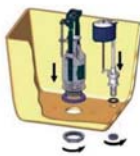
Şəkil 6. Axıdıcı çənə yeni armaturun quraşdırılması
