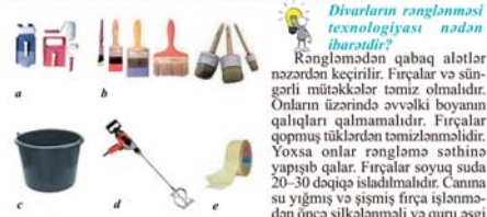
Şəkil 2. Rəngləmə üçün alət və materiallar: a – süngərli mütəkələr; b – fırçalar (yastı və yumru); c – boya üçün vedrə; d – drel-misker; e – şüşənin çirklənmədən qorunması üçün şəkə.
