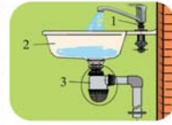
Şəkil 1. Əlüzüyanın quruluşu: 1 – suqarışdırıcı; 2 – çanaq; 3 – sifon
