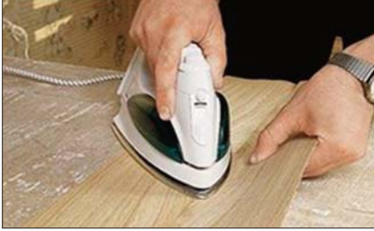
Şəkil 8. Ütü vasitəsilə şponun yapışdırılması
