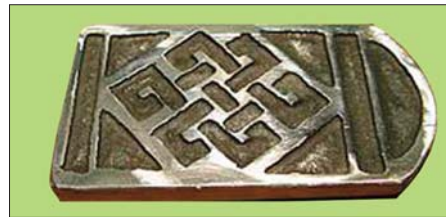
Şəkil 5. Aşınma üsulu ilə bəzədilmiş metal
