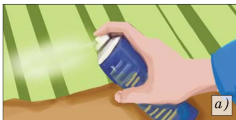
Şəkil 1. Metalın rənglənməsi və ya laklanması: a) tozlandırma üsulu ilə; b) fırça ilə
