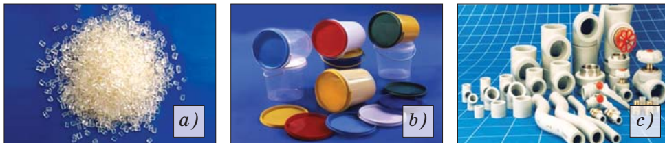
Şəkil 3. a) polipropilen; b) polipropilen mətbəx avadanlığı; c) polipropilen santexnika avadanlığı
