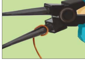
Şəkil 9. Halqanın alınması
