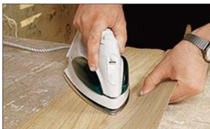
Şəkil 8. Ütü vasitəsilə şponun yapışdırılması
