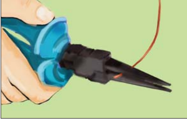
Şəkil 8. Məftilin ucunun sıxılması
