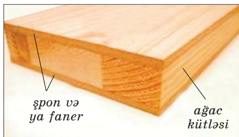
Şəkil 4. Xarrat lövhəsinin konstruktiv xüsusiyyətləri
