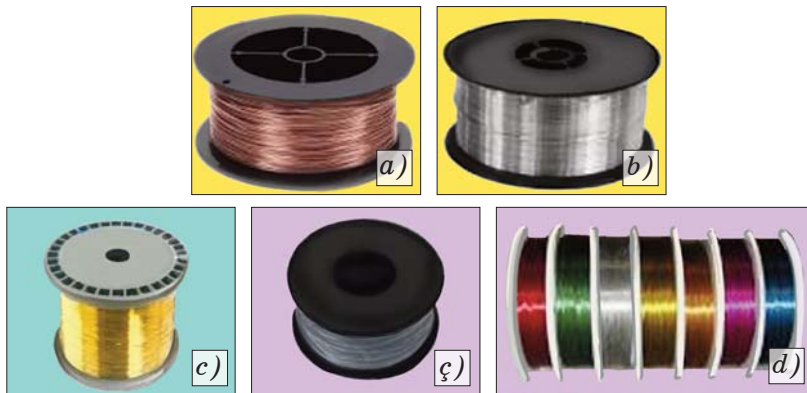
Şəkil 1. Əlvan metallardan məftillər: a) mis; b) alüminium; c) latun; ç) sink; d) nəbatətli
