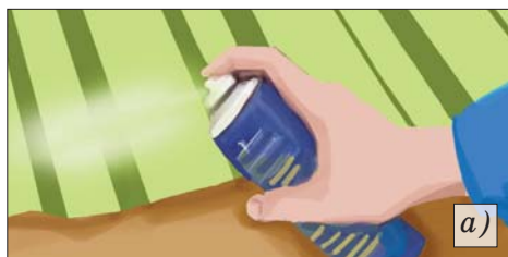
Şəkil 1. Metallın rənglənməsi və ya laklanması: a) tozlandırma üsulu ilə; b) fırça ilə
