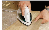
Şəkil 8. Ütü vasitəsilə sponun yapışdırılması
