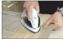
Şəkil 8. Ütü vasitəsilə sponun yapışdırılması
