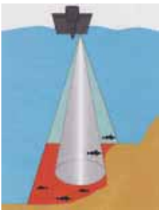
თანამედროვე პერიოდში ოკეანეებში წყლის სიღრმე განისაზღვრება ექოლოტის დახმარებით
